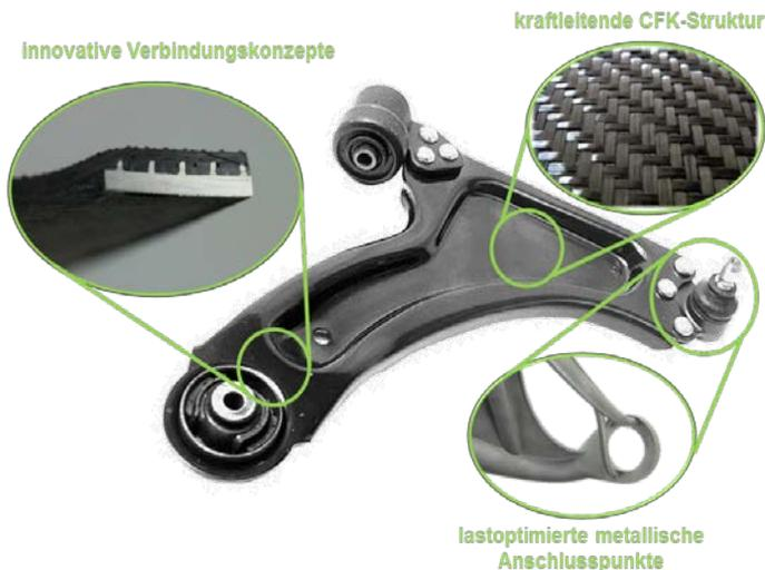
**Abbildung 4: Prinzip des hybriden Querlenkers.**
